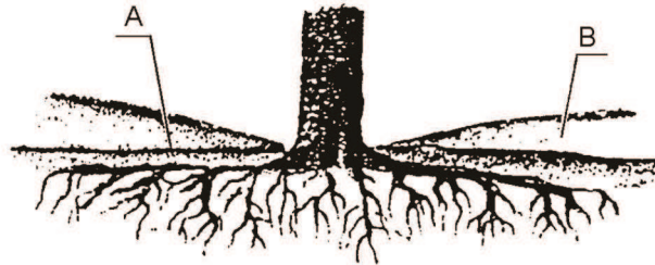
Rys. 3. Niecka o łagodnym pochyleniu, dostosowująca drzewo do otaczającego terenu podwyższonego o 0,2 ÷ 0,4 m (wg [10])
