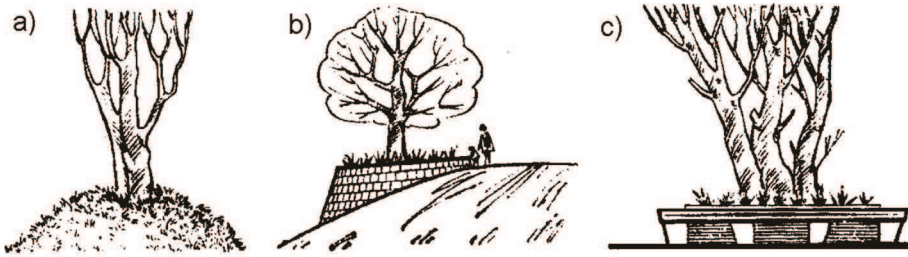
Rys. 2. Zabezpieczenie drzew przy obniżeniu terenu, po wykonaniu wykopów
