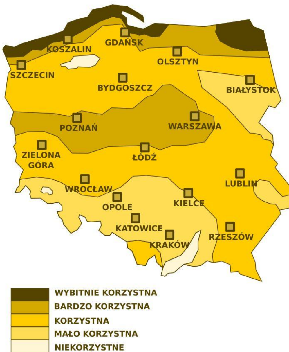
Rysunek 12: Mapa wietrzności Polski uwzględniająca dogodność lokalizacji dla elektrowni wiatrowych (źródło: http://www.instalacjebudowlane.pl )
