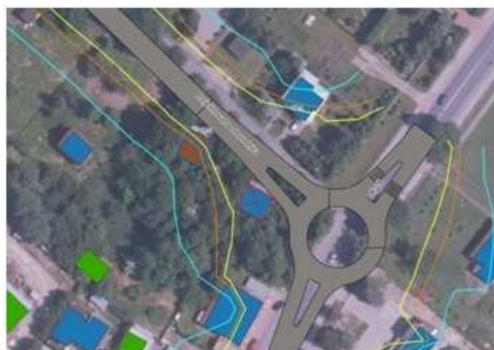
Rys. 8.3. Zasięgi izolinii hałasu w Wariancie W1 etap I – z uwzględnieniem oddziaływania skumulowanego z DK-28.
